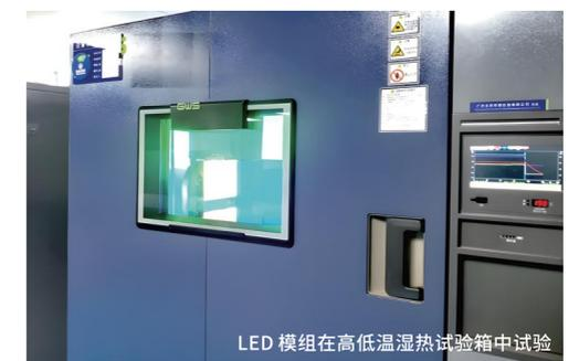
LED 模组在高低温湿热试验箱中试验
